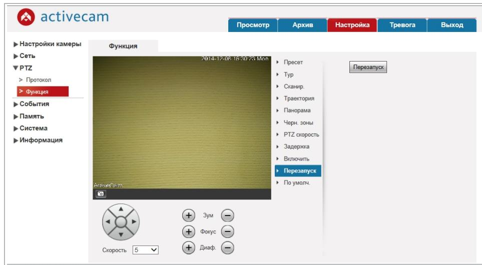
Нажмите кнопку **Перезапуск [PTZ Restart]** для перезапуска поворотного механизма камеры.
